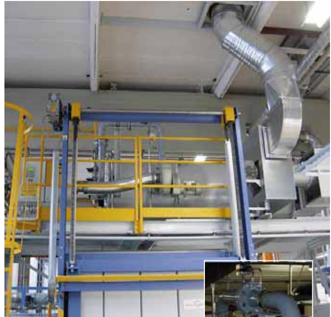
带热燃式尾气处理装置的燃气融蜡炉，西门子 S7 控制器，带触摸屏。
